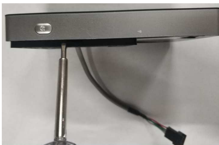
Zdjęcie ilustrujące sposób zwolnienia blokady umożliwiającej demontaż kontrolera po zamontowaniu na ścianie wnętrza budynku.
